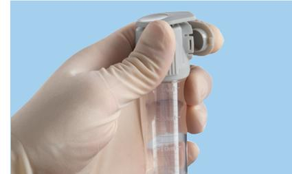
Leicht schließender Deckel zur Versiegelung einer entnommenen Probe
