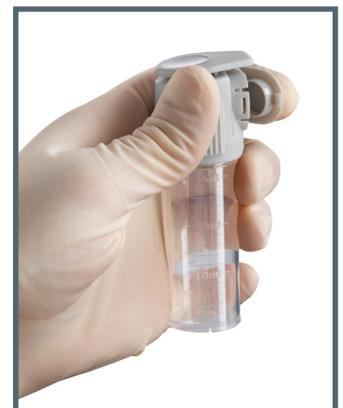
Leicht schließender Deckel zur Versiegelung der entnommenen Probe
